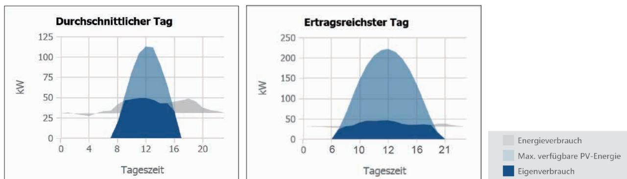
Darstellung am Beispiel des Rechenzentrums mit 269,28 kWp. Die Berechnungsdaten beziehen Geo- und Wetterparameter mit ein.
